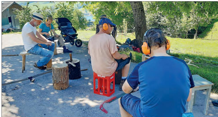
Damit das Mähen mit der Sense gelingt, muss das Sensesblatt regelmässig gedengelt und gewetzt werden.
