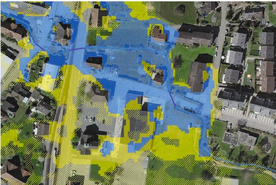
*Gefahrenkarte Hochwasser mit Orthofoto, Stand 2011: Vor dem Hochwasserschutzprojekt ging vom Talbach in Hirschthal eine mittlere Gefährdung aus (blau: mittlere Gefährdung, gelb: geringe Gefährdung, gelb schraffiert: Restgefährdung).*
